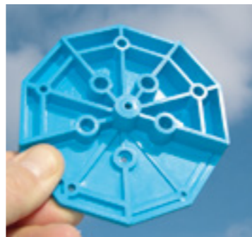
Das Helical ist eine Montageplattform zur Aufnahme des Winkelmessgeräts. Fünf unterschiedliche Randstärken des Zehnecks und definiert angebrachte Befestigungsbohrungen sorgen dafür, dass man es in alle gängigen Blatthalter montieren kann
