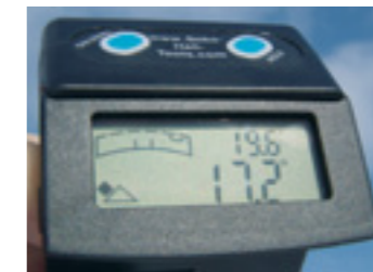
Das Display hat zwei Anzeigebereiche. Im oberen wird der absolute Winkel (Wasserwaage) angezeigt, im unteren der relative Winkel zum zuletzt eingestellten Nullpunkt
